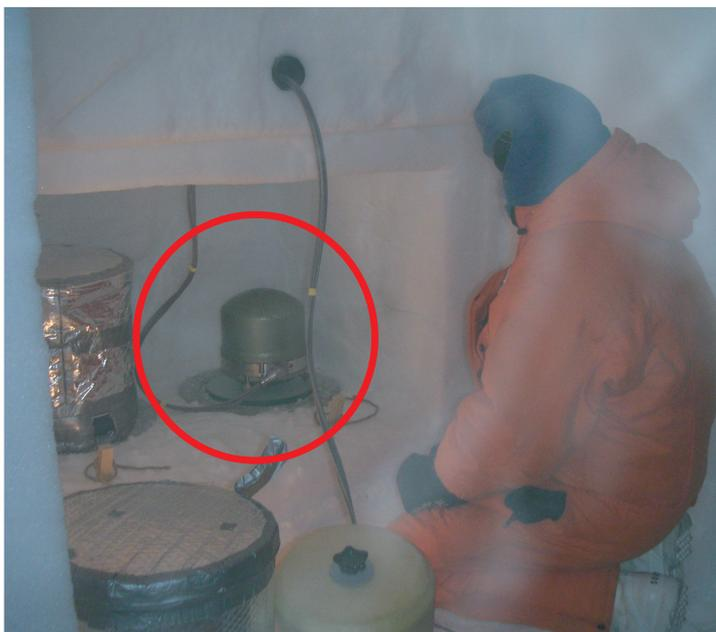
Sismomètre STS2 actuellement en place sur le continent antarctique, dans la cave sismologique de la base Concordia à -58°C, à 10 m de profondeur dans la glace.
